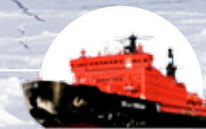
На сегодняшний день ледокол «50 лет Победы» – самый большой атомный ледокол в мире. Его длина достигает почти 160 м, а высота борта превышает 17 м. Судно оснащено двумя ядерными реакторами, вырабатывающими 75 000 л.с. Максимальная скорость ледокола – 21 узел, или приблизительно 39 км/ч.
